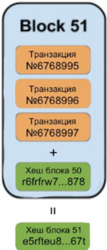
Рис. 2. Структура блока технологии blockchain
