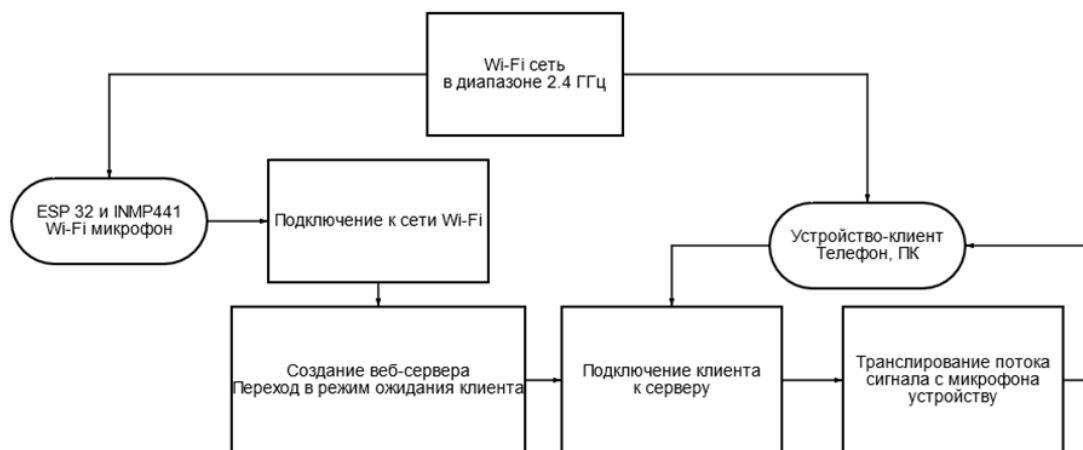
Рис. 5. Схема сеанса связи между клиентом и сервером
