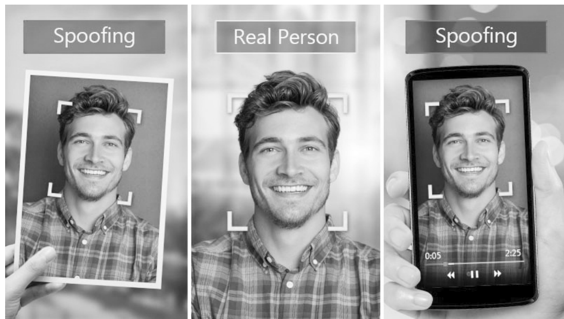
Рис. 1. Примеры атак с использованием распечатанной фотографии и с помощью визуализации изображения на экране смартфона
