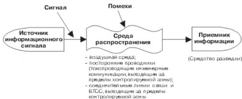
Рис. 1. Общая схема технического канала утечки информации
