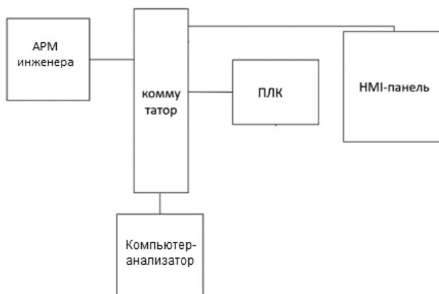
Рис. 2. Схема сетевых соединений второго сегмента лабораторного стенда
