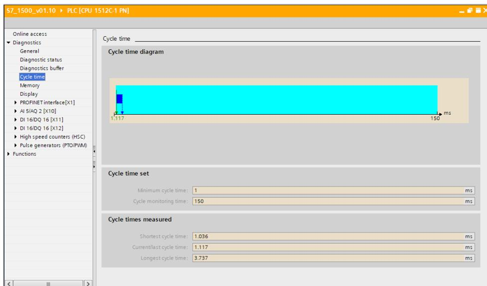
Рис.4. Базовое время цикла
