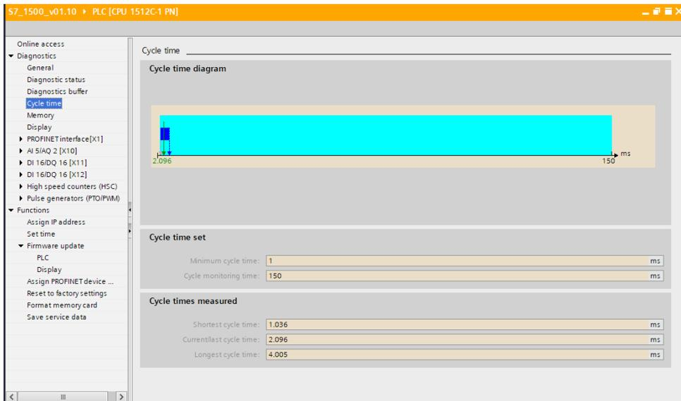
Рис.5. Время цикла под нагрузкой
