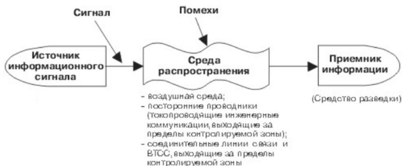
Рис. 1. Общая схема технического канала утечки информации
