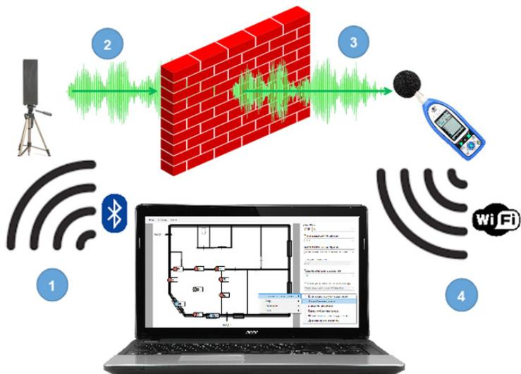
Рис. 6. Общий принцип работы комплекса
