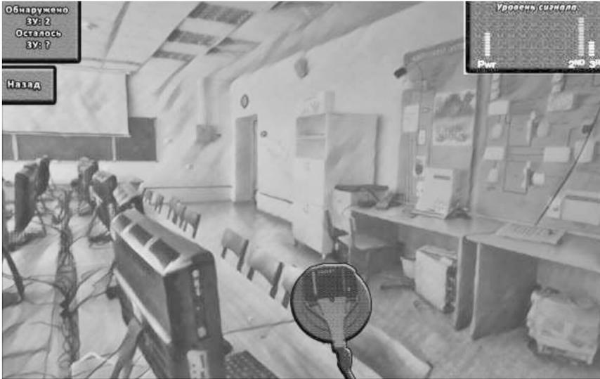
Рис. 5. Скриншот работы с нелинейным локатором (с индикацией уровней мощности передачи и принятых сигналов 2-й и 3-й гармоник)
