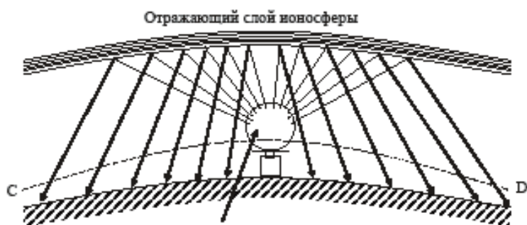
Рис. 4. Изменение напряженности поля ионосферного луча в зависимости от удаления от передатчика
