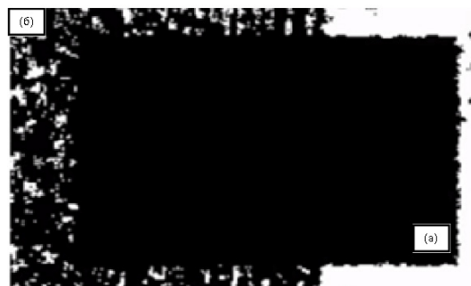
Рис. 9. Карта пикселей областей со встраиванием (а) и области без встраивания (б) после обработки фильтром
