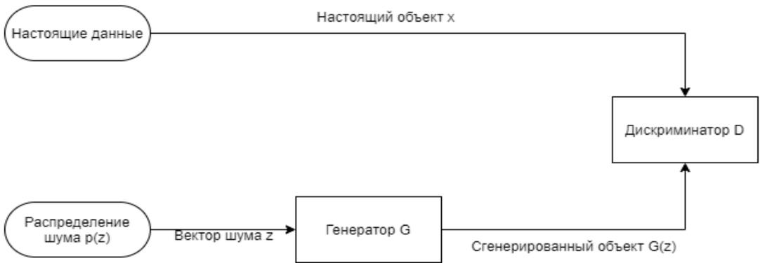
Рис. 7. Схема ИНС с генеративно-сопоставительной архитектурой (GAN)
