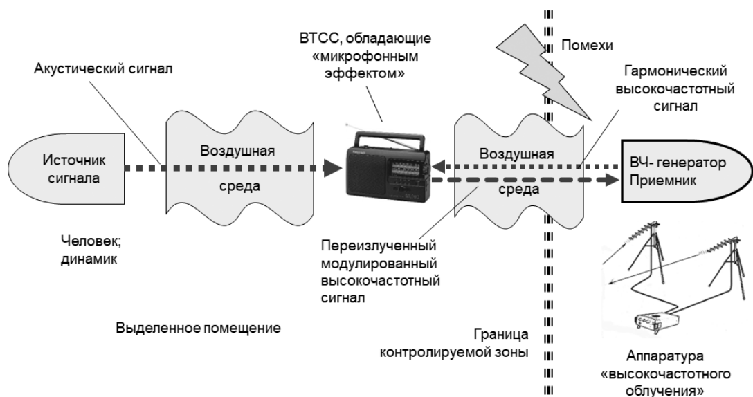
Рис. 3. Схема акустоэлектромагнитного канала утечки речевой информации, создаваемого методом «высокочастотного облучения»
